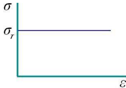
Рисунок 3 – Модель жестко - пластической неупрочняющейся среды
